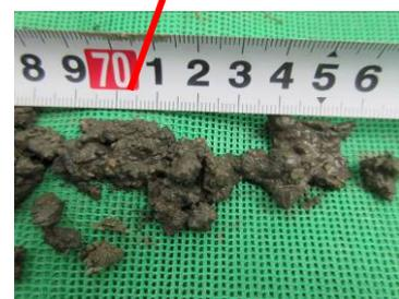
過去にも調査した内容とほぼ類似しており、池水面と同じ深さより上部に向かってグライ化が進んでいる。植栽から数十年で有効土壌が減少する傾向が良くわかる。数年に1回隣接地を調査し、有効土壌の計測と、改善効果を検証しています。
